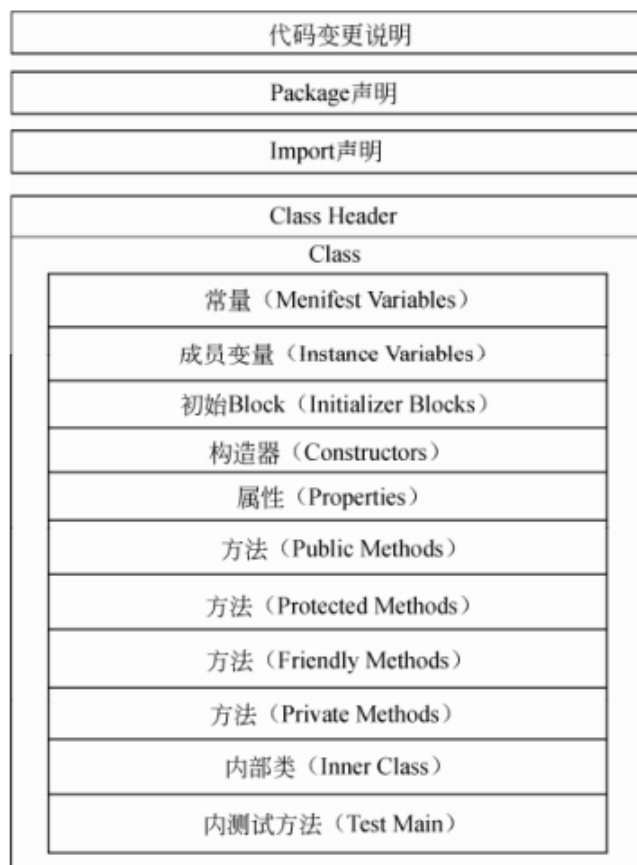
图 2.1 一个规范的 Java 类或接口程序文件的代码结构
